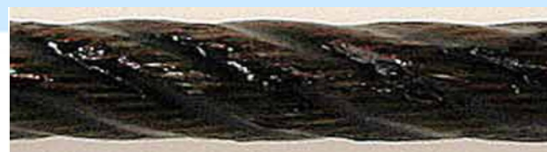
(รูปที่ 3) ลวดสลิงที่หล่อลื่นด้วยจาระบี
