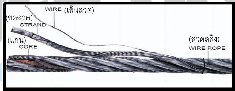
(รูปที่ 1) แสดงส่วนประกอบของลวดสลิง
