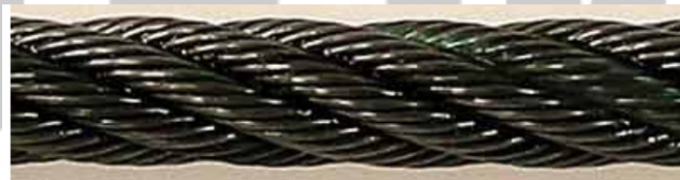
(รูปที่ 2) ลวดสลิงที่หล่อลื่นด้วยการหล่อลื่นแบบแทรกซึม
